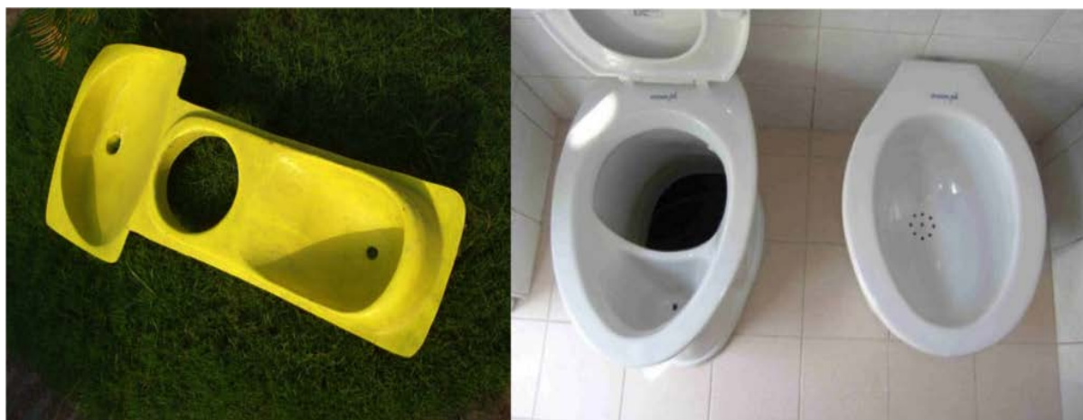
ESQUERDA: Vaso sanitário ao estilo turco, de plástico reforçado, com desvio de urina e cuba coletora para a água de limpeza anal (Fonte: WAFLE - 2010). DIREITA: Vaso cerâmico com pedestal e desvio de urina, e vaso separado para coleta de água de limpeza anal (Fonte: UNESCO-IHE).
